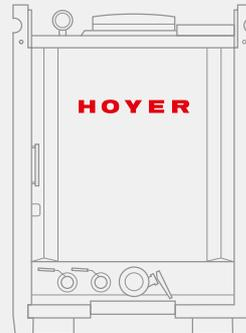
**Tipo 434 / 436 – IBC riscaldabile elettricamente e a vapore**
